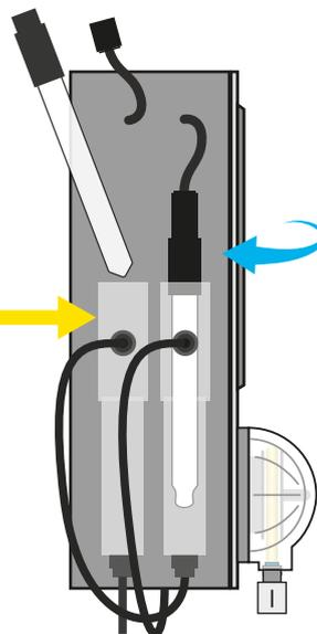
Sondendurchflussarmatur für die CLF-Sonde oder die Redox-Sonde
