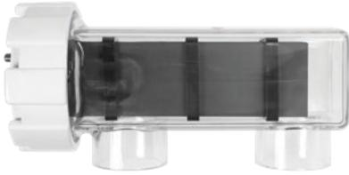
Die Elektrolysezelle TE25 wird an die Ausgangswasserrohrleitung von der Filtration in den Schwimmbecken montiert. Montage wird in den direkten Teil der Rohrleitung DN 50 durch das Ankleben durchgeführt . Der Satz für die ankleben wird nicht mitgeliefert.
